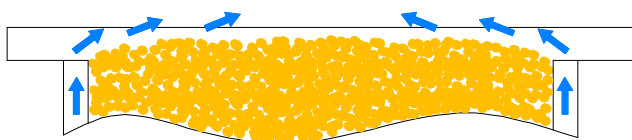
Rys. 7. Usytuowanie pelet względem rusztu palnika retortowego podczas pracy kotła.
