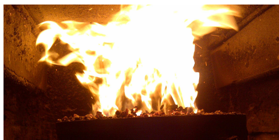
Rys. 7. Usytuowanie pelet względem rusztu palnika retortowego podczas pracy kotła.
