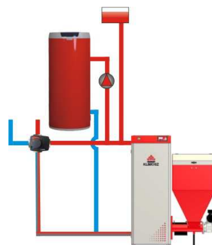
Rys. 9. Układ ogrzewania w trybie LATO – tylko c.w.u.
