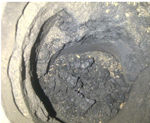
Rys. 14. Nagar powstały podczas spalania pelet – widok kolana retorty z góry.
