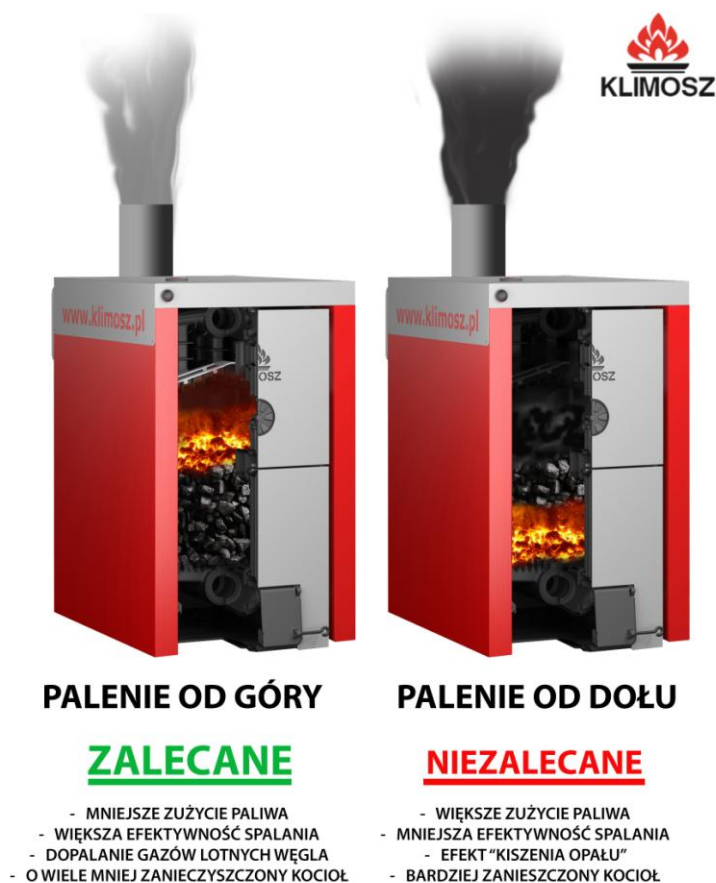
Rys.13. Schemat palenia od góry i od dołu.
