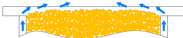
Rys. 9. Usytuowanie pelet względem rusztu palnika retortowego podczas pracy kotła.
