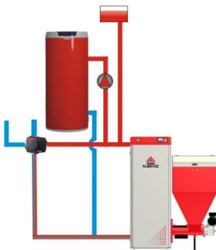
Rys. 12. Układ ogrzewania w trybie LATO – tylko c.w.u.
