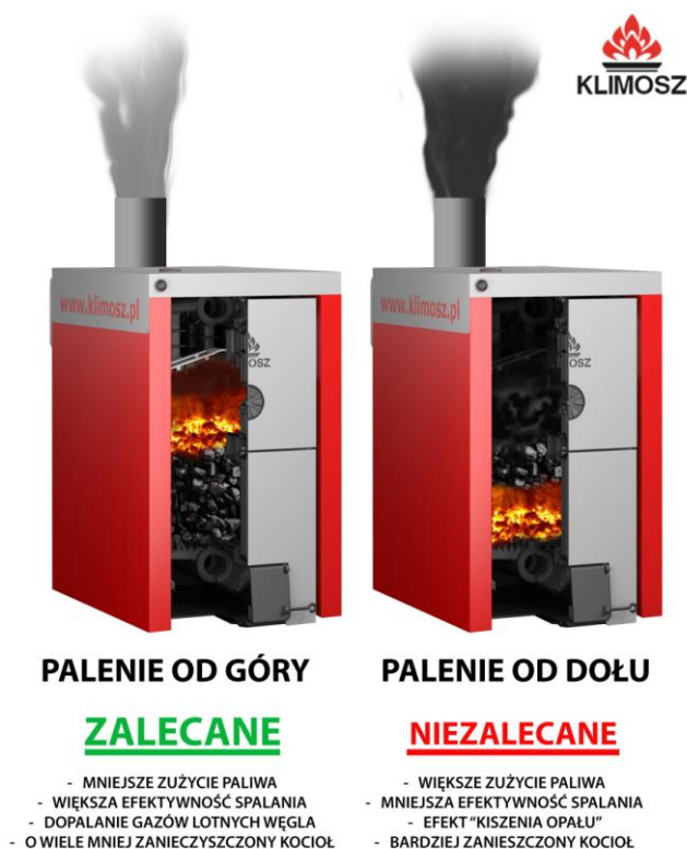
Rys.13. Schemat palenia od góry i od dołu.
