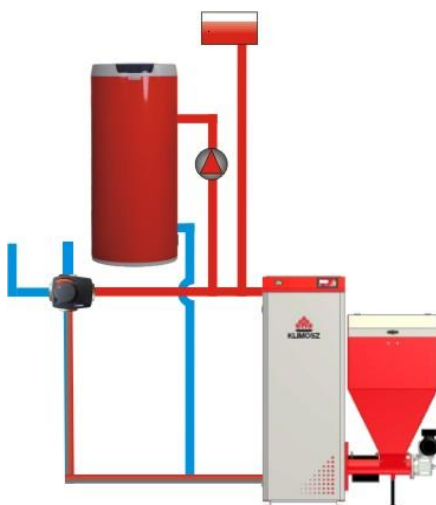
Rys. 12. Układ ogrzewania w trybie LATO – tylko c.w.u.
