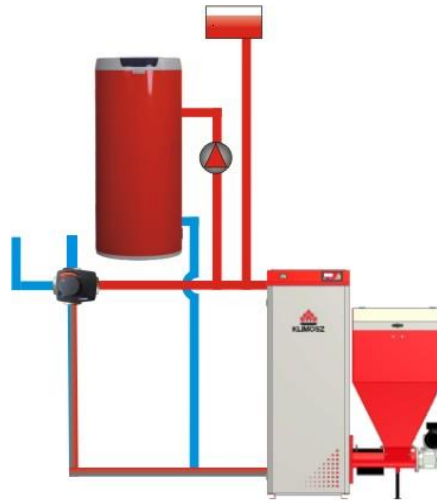
Układ ogrzewania w trybie LATO – tylko c.w.u.
