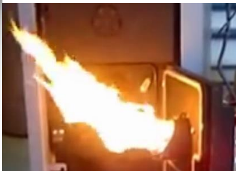
Praca palnika peletowego oraz biomasowego rynnowego z samozapłonem.
