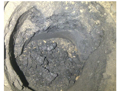
Nagar powstały podczas spalania peletu – widok retorty z góry
