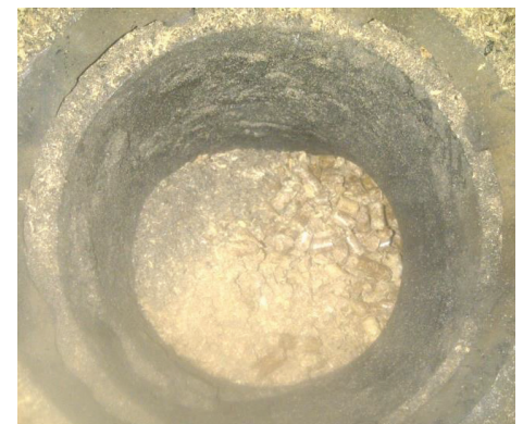
Palnik oczyszczony z nagaru – widok retorty z góry
