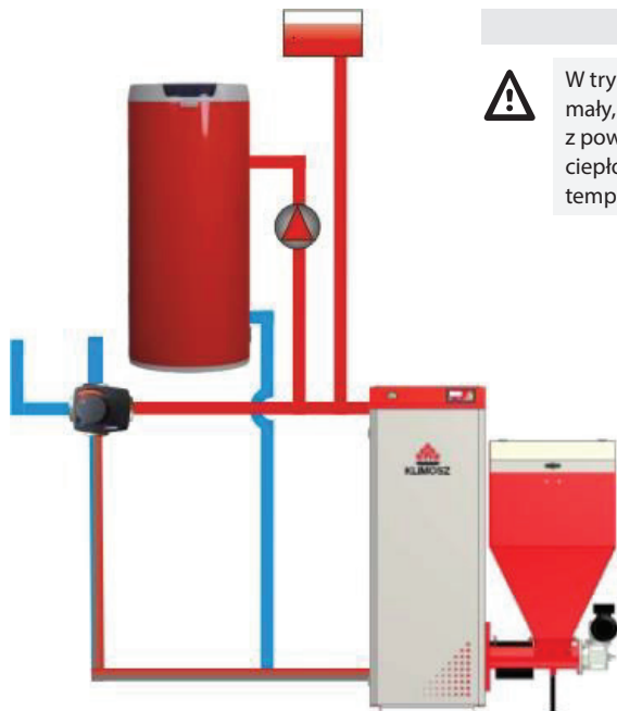
Układ ogrzewania w trybie LATO – tylko c.w.u.
