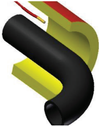
Rys. Umiejscowienie czujnika temperatury
