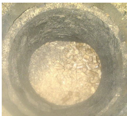
Palnik oczyszczony z nagaru
