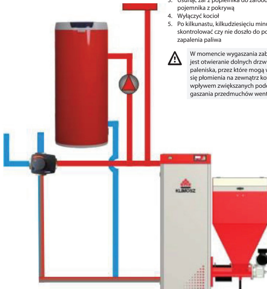
Układ ogrzewania w trybie LATO – tylko c.w.u.
