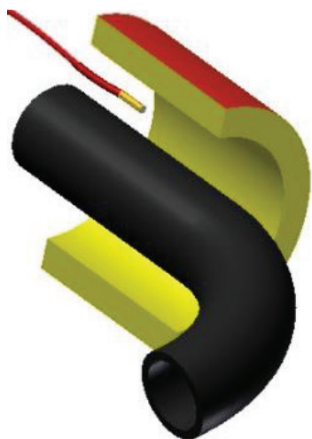
Rys 11. Umiejscowienie czujnika temperatury
