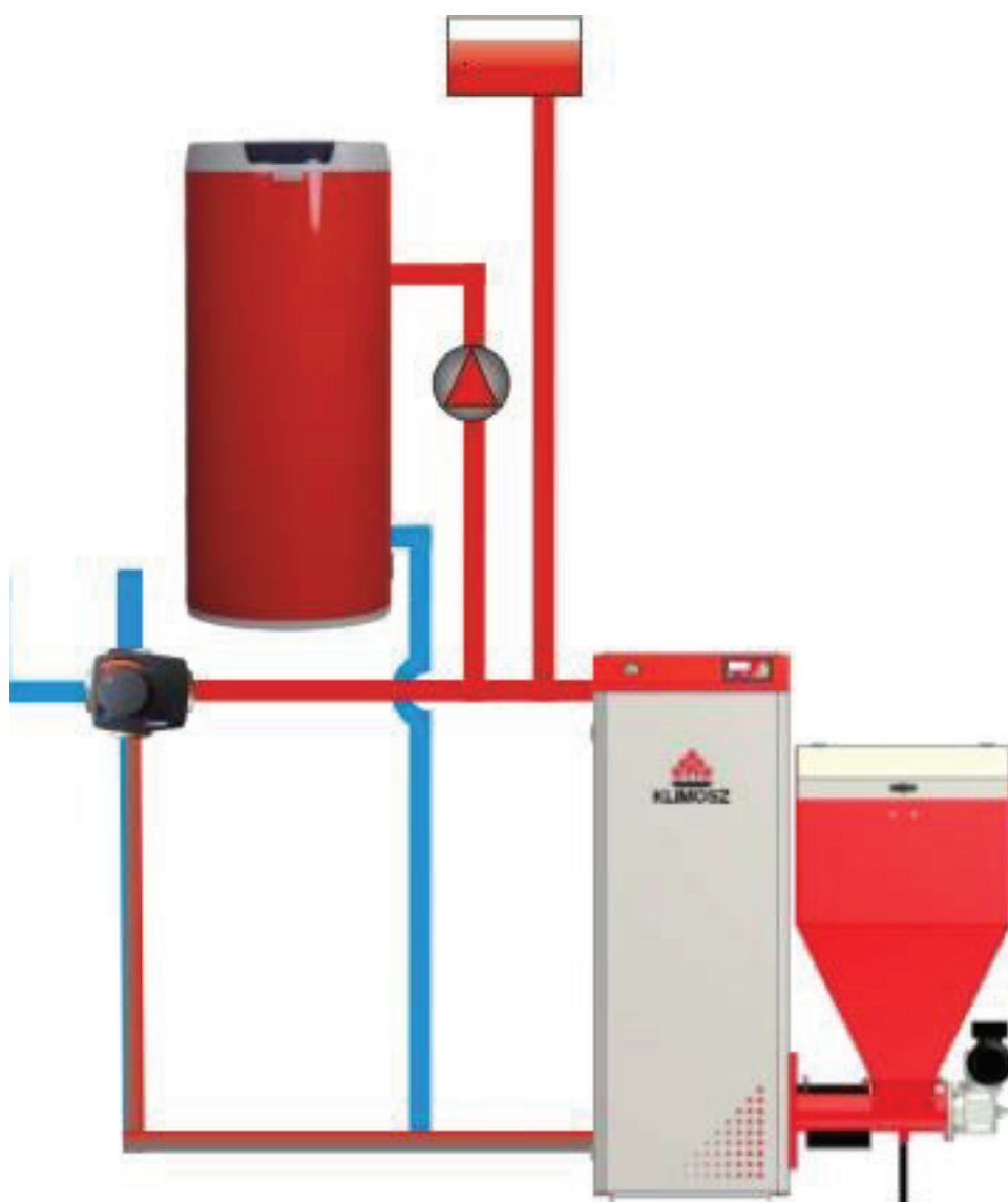
Rys 15. Układ ogrzewania w trybie LATO – tylko c.w.u.
