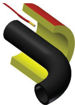
Rys. Umieszczenie czujnika temperatury
