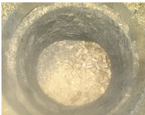
Palnik oczyszczony z nagaru – widok retorty z góry
