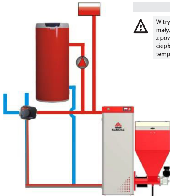
Układ ogrzewania w trybie LATO – tylko c.w.u.
