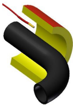
Schemat umieszczenia czujnika temperatury
