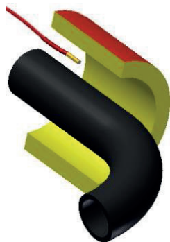
Schemat umiejscowienia czujnika temperatury
