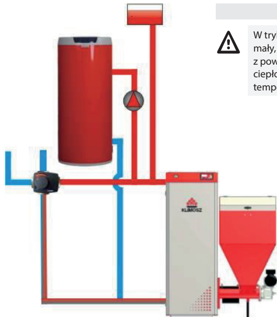
Układ ogrzewania w trybie LATO – tylko c.w.u.
