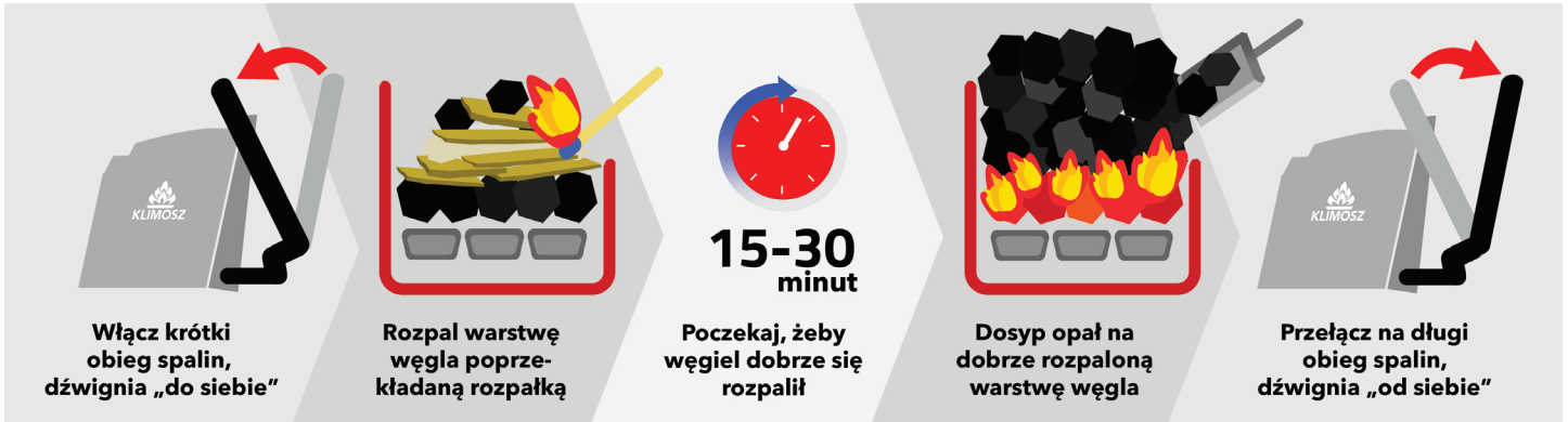
Rys. 5 Instrukcja rozpalania kotła
