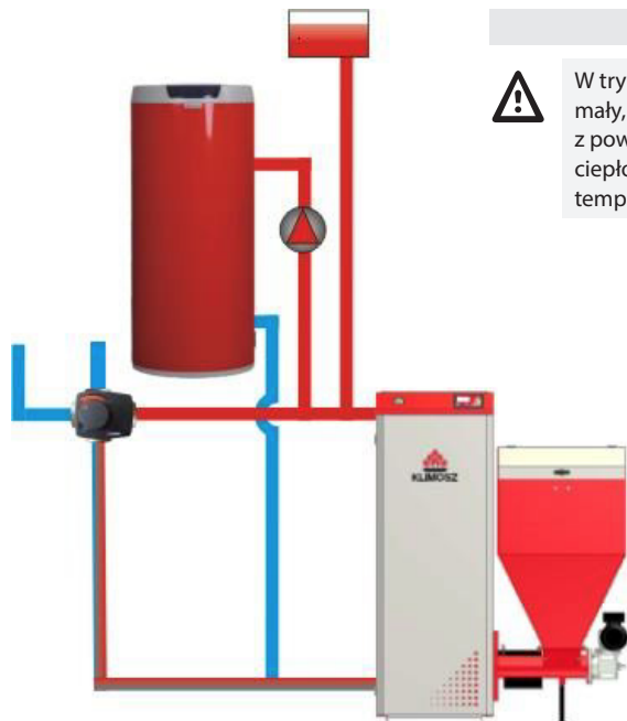
Układ ogrzewania w trybie LATO – tylko c.w.u.
