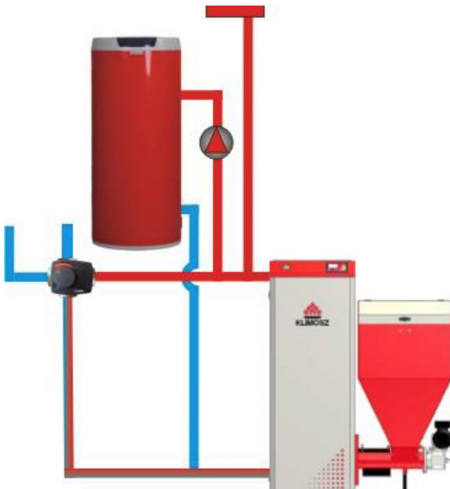
Układ ogrzewania w trybie LATO – tylko c.w.u.
