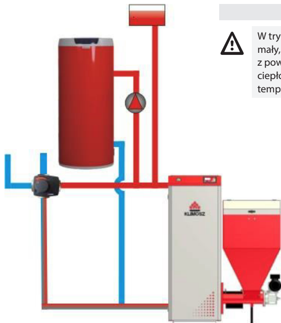
Układ ogrzewania w trybie LATO – tylko c.w.u.
