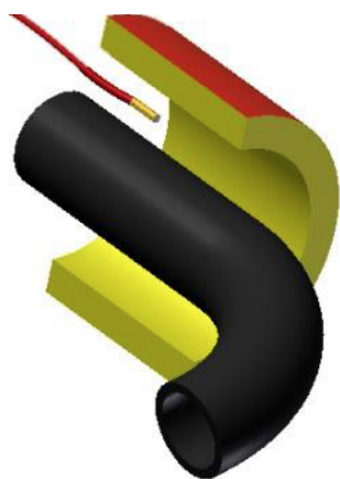
Rys. Umieszczenie czujnika temperatury
