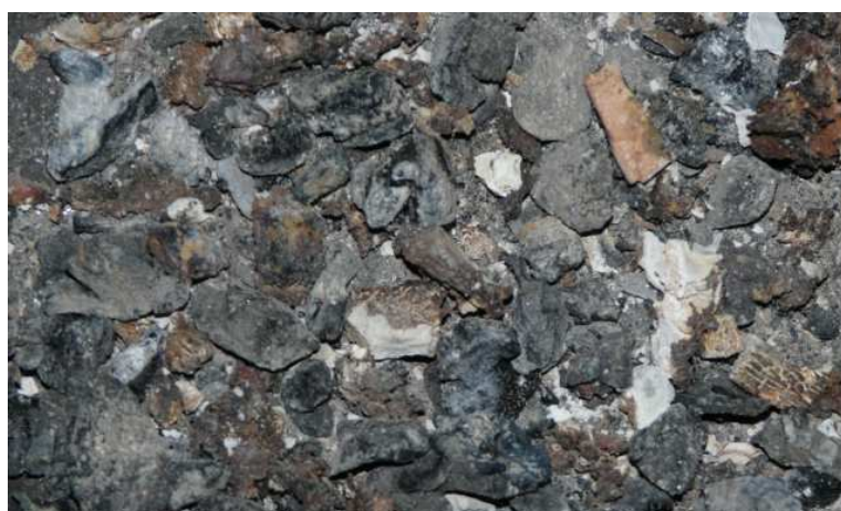
Rys. 26. Spiekanie węgla – niepoprawna regulacja palnika względem jakości paliwa.
