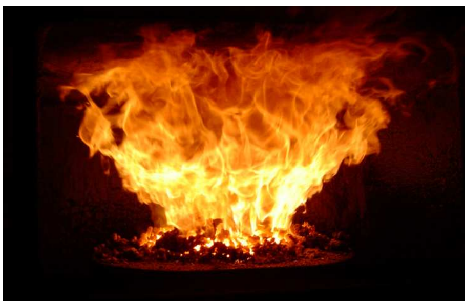
Rys. 25. Praca palnika retortowego podczas opalania węglem Ling, Ling Duo 75kW.
