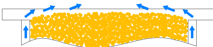
Rys. 27. Usytuowanie pelet względem rusztu palnika retortowego podczas pracy kotła.
