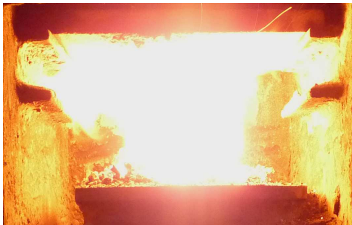
Rys. 24. Praca palnika retortowego podczas opalania węglem Ling, Ling Duo 15 ÷ 50kW.
