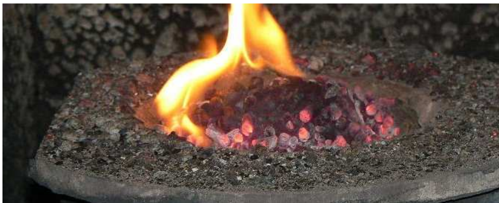
Rys. 28. Usytuowanie pelet względem rusztu palnika retortowego podczas pracy kotła.
