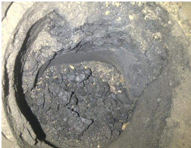
Rys. 11. Nagar powstały podczas spalania peletu – widok retorty z góry.
