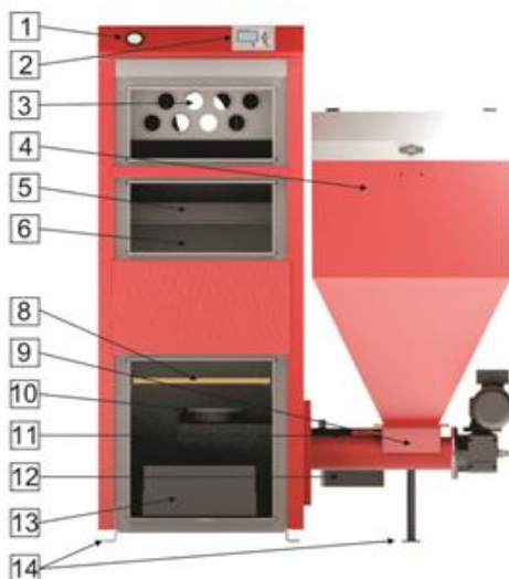
Rys 16. Opis kotła KLIMOSZ DUO oraz MULTIDUO (na przykładzie kotła w wersji NG)
