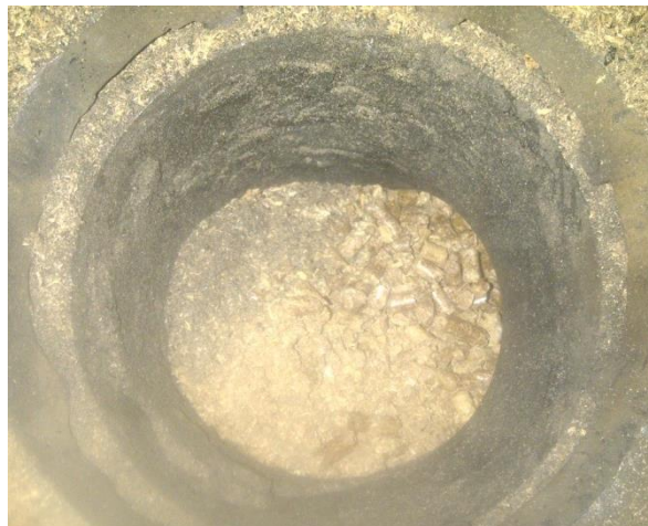
Rys. 12. Palnik oczyszczony z nagaru – widok retorty z góry.
