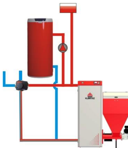
Rys. 10. Układ ogrzewania w trybie LATO – tylko c.w.u.
